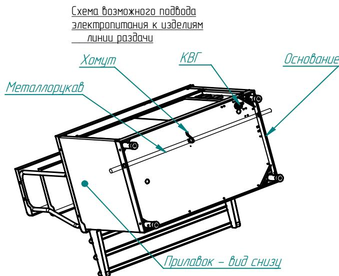
В основаниях изделий линии раздачи введено сквозное отверстие диаметром 29,5 мм и поддерживающие хомуты для возможности проведения металлического кабеля с питающими кабелями сквозь все изделия линии раздачи.
