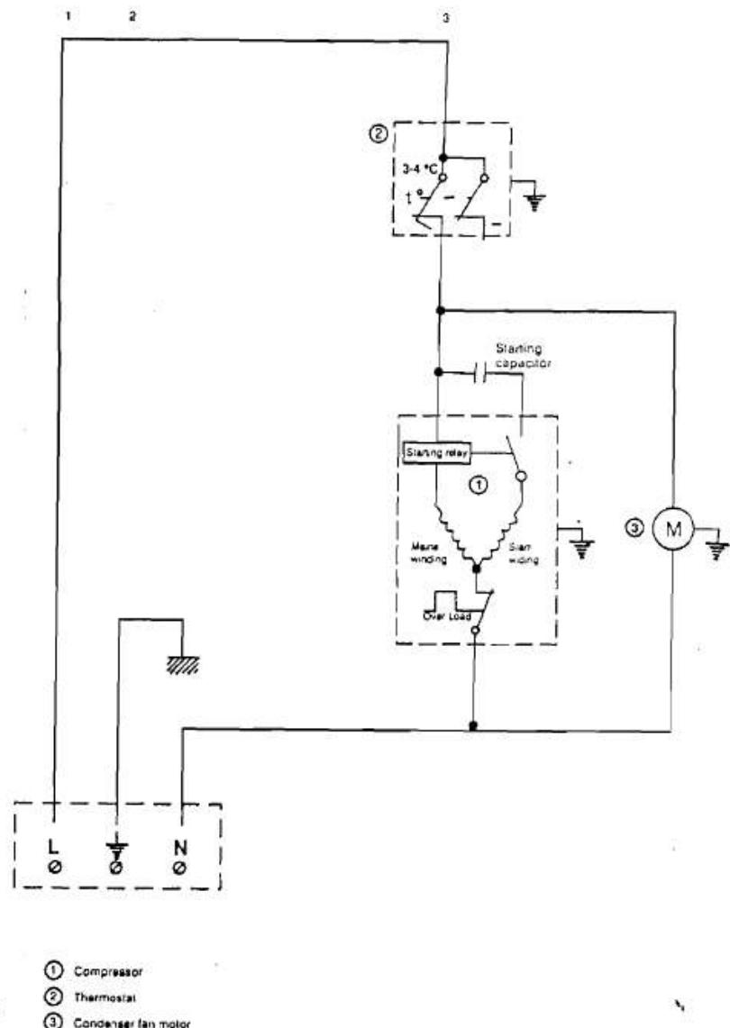
1-компрессор; 2-термостат; 3-двигатель вентилятора конденсатора; 4-запускающий конденсатор; 5-запускающее реле; 6-сетевая обмотка; 7-запускающая обмотка; 8-перегрузка.
