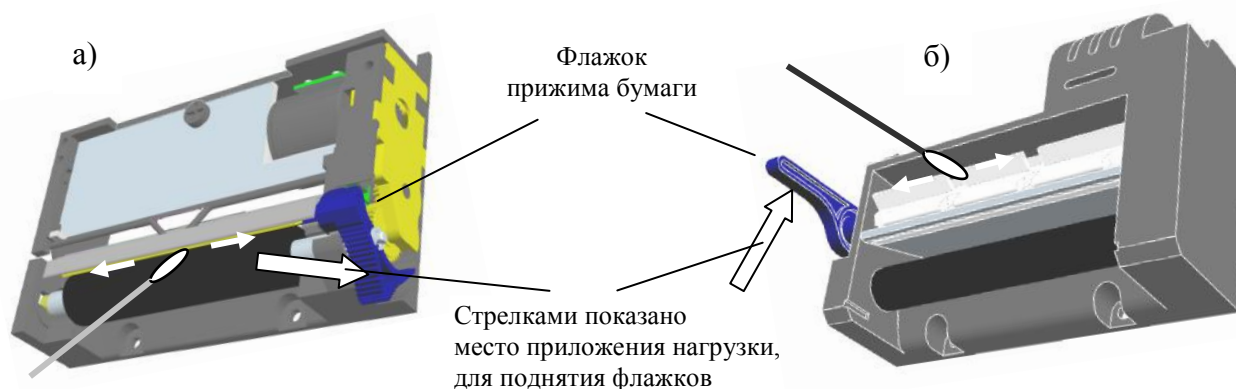
Рис. 28 - Чистка термоголовки принтера
