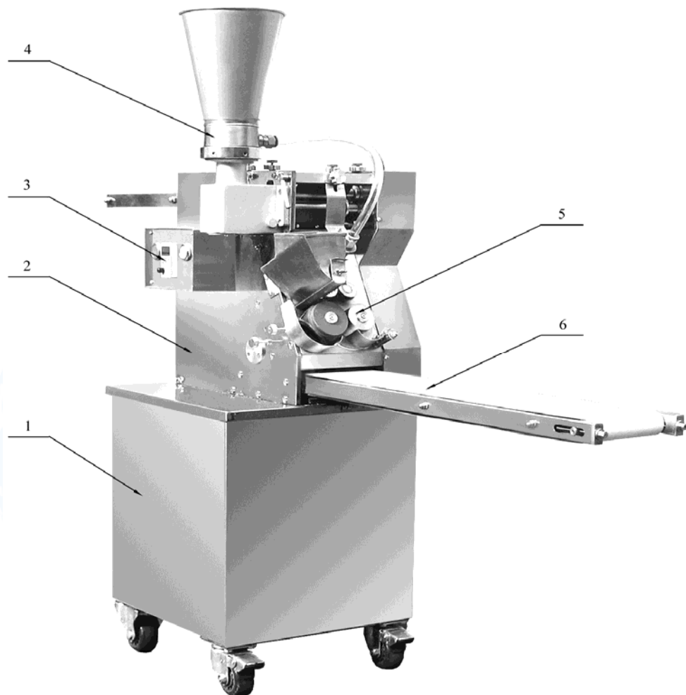
1. Корпус; 2. Станина; 3. Панель управления; 4. Воронка; 5. Формовщик; 6. Транспортерная лента.
