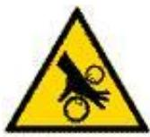
**ВНИМАНИЕ: В ходе функционирования машины категорически запрещается снимать защитные устройства в связи с наличием движущихся органов, которые могут вызвать сдавливание рук.**
