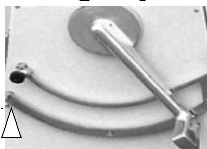
Отрегулировать раскрытие цилиндров посредством ручага на рисунке. Переместив его вправо получается минимальное раскрытие между цилиндрами, влево - максимальное. По завершении регулирования, заблокируйте положение рычага, зафиксировав указанный стрелкой маховиком.
